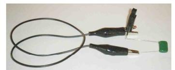
静電容量が小さくて耐電圧が大きなコンデンサーを 10 種類秋月電子から購入して実験した。圧電素子の正極、負極を直接コンデンサーに接続すると、何回か行っているうちに壊れるようなので、負極とコンデンサーの金属線の間を数ミリメートル開けて火花放電を起こさせて電気を蓄電させた。この方法では全部の電子が移動するか(空気中等に逃げないか)定かではなかったが行ってみることにした。また、圧電素子を手でカチッと押して放電させるのであるが、毎回同じ量の電気が発生しているかは不確かであった。まずは実験をしてみて結果を検討してみることにした。
