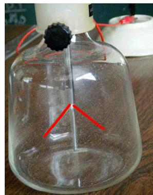
正電極を使った実験。箔の開きを赤線で示している。
